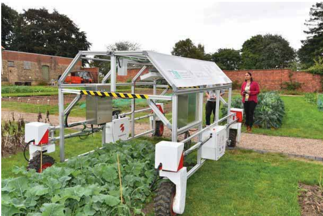
Rover autonomo Thorvald (fenotipizzazione)
